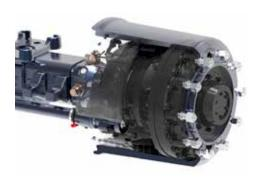
A fékszerkezet felújítása és cseréje könnyen, a hajtómű megbontása nélkül végezhető.
